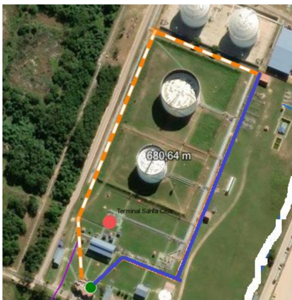
Figura 4. Tendido referencial de Fibra Óptica SS-001/SS-002
