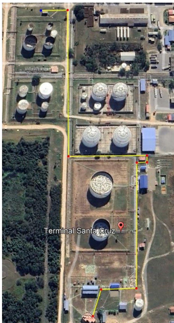
Figura 5. Tendido referencial de Fibra Óptica SCP-001/SCP-003
